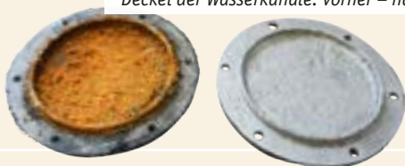
Deckel der Wasserkanäle: vorher – nachher.
